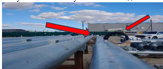
Рисунок 4 - допуск расположения отвода
